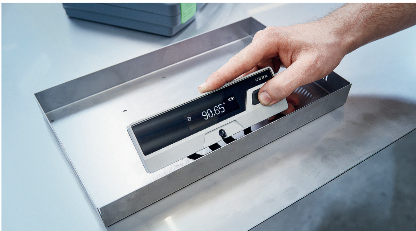
Le misurazioni angolari, sia manuali sia automatiche sulla linea di produzione, sono effettuate in maniera comoda, veloce e precisa grazie al misuratore angolare KeMes di Wila.
